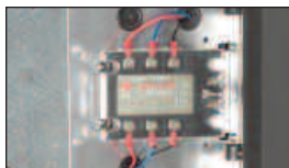
control de estado sólido del motor no hay contactos de relé que se gasten o quemen
